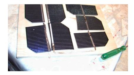
Jetzt müssen die Anschlüsse angelötet werden, an der ersten und letzten Zelle der Reihenschaltung, an denen der erzeugte Strom später abgenommen werden kann
