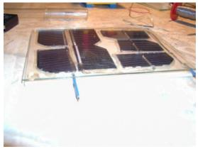
Nun müssen die Seiten noch abgedichtet werden (Dies kann auch mit Acryl- bzw. Silikonkitt geschehen). Die Rückseite ist noch mit einer Lackschicht zu versehen, damit keine Feuchtigkeit zu den stromführenden Zellen gelangt, was zu Verlusten bis hin zur Funktionsunfähigkeit durch Kriechströme führen würde.
